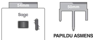
Ja jums nepieciešams 50 mm asmens, pagrieziet regulēšanas skalu tālāk par Nr. 1, līdz 54 mm asmens ir pilnībā izvilkts un to var izņemt no korpusa.
